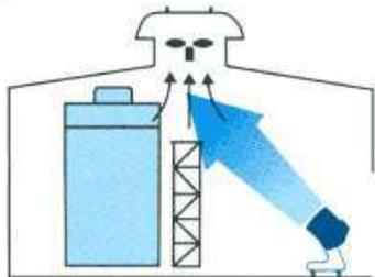
フォローウインドは到達距離が長く、離れた場所から外気や冷風を飛ばすことができ、鑄鍛造作業や高所高熱作業などでは体感温度の低下に役立ちます。
