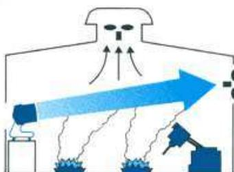
溶接工程で発生するヒュームなどは、屋外排気ファンへフォローウインドで誘導することにより、工場内の空気を効率よく浄化できます。
